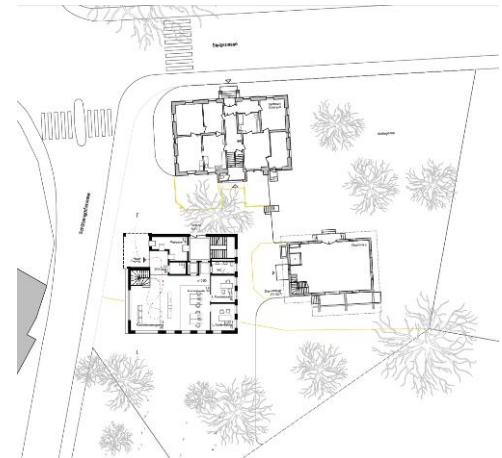
Im Zuge der Erkenntnisse aus der ortsbaulichen Analyse und zum Ensemble, modellieren die Architekten einen neuen Baukörper ohne direkte funktionale Verknüpfung mit dem Haupthaus. Das neue Bankgebäude baut sich in den Strassenzug der Schützengütlstrasse ein und strahlt als selbstbewusstes Kleinstadthaus. Mit der Positionierung des Haupteinganges erhält die Bank zudem eine angemessene Vorfahrt.
